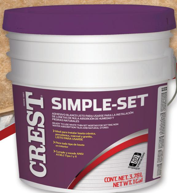
Adhesivo en pasta, listo para usarse, diseñado para la colocación de todo tipo de recubrimientos de alta, media, baja y nula absorción de humedad sobre superficies como tabla-yeso, tabla-cemento, madera contrachapada y cemento-arena. Formulación base látex-acrílico, con una gran adherencia y fácil aplicación. Tiene excelente resistencia al deslizamiento vertical una vez aplicado. Cumple con las especificaciones ANSI A 136.1 Tipo I y II.
