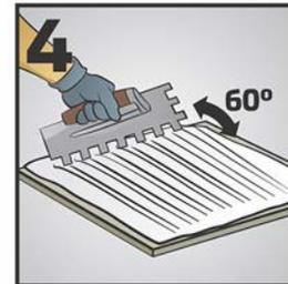
4 Coloque el adhesivo en la parte posterior de la loseta utilizando la parte plana de la llana sosteniéndola en un ángulo de 60° de la superficie, y después con la sección dentada de la llana inclinada a 60°.
