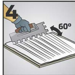
Coloque el adhesivo en la parte posterior de la loseta utilizando la parte plana de la llana sosteniéndola en un ángulo de 60° de la superficie, y después con la sección dentada de la llana inclinada a 60°.
