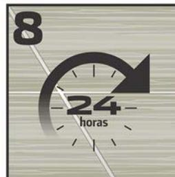
Una vez terminada la instalación, será necesario esperar 24 horas para juntear o emboquillar (este tiempo puede variar por las condiciones de clima).
