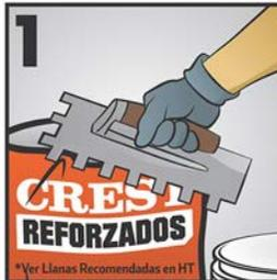
Utilice una llana dentada de tamaño apropiado, dependiendo del formato de la loseta a instalar. Que tenga suficiente profundidad para que el adhesivo alcance un área de contacto con la loseta y con el sustrato mayor del 85%
