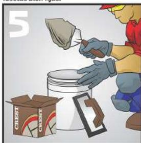
Mezcle de nuevo y el JuntaCrest Ultramax quedará listo para su uso. Si el material llega a tornarse rígido antes de usarlo todo (aproximadamente 1 hora), mezcle nuevamente, sin agregar agua.
