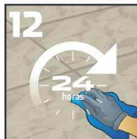
Finalmente limpiar la superficie con un trapo limpio y seco. Para curar el emboquillado, espere 24 horas después de la instalación.
