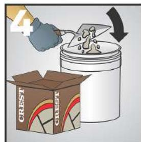
Agregue una caja de 5 kg de JuntaCrest Ultramax. Revuelva bien hasta formar una mezcla homogénea. Deje reposar la mezcla durante 10 minutos.
