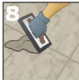
Remueva el exceso de JuntaCrest Ultramax de la superficie de la loseta con la llana de esponja dura con movimientos diagonales a la junta, cuando la mezcla este todavía fresca.
