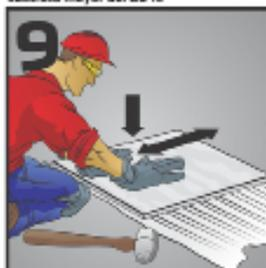
**9** Coloque la loseta con los cordones paralelos a los cordones del sustrato procurando moverlas ligeramente hacia arriba y abajo en sentido perpendicular al rayado del adhesivo.
