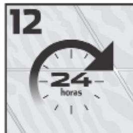
**12** Una vez terminada la instalación, será necesario esperar 24 horas para juntar o emboquillar (este tiempo puede variar por las condiciones de clima).
